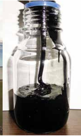
Il combustibile BTZ usato nell'inceneritore in fase di accensione
